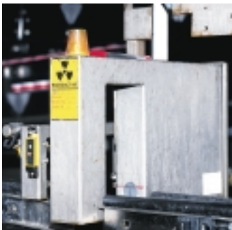
Fuentes radiactivas: Medidor de nivel de llenado de botellas en una fábrica.
