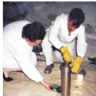
Retirada de una fuente de neutrones en un centro de investigación.
