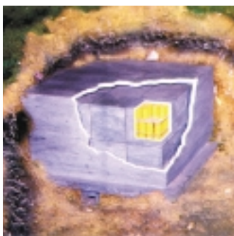
Concepto de clausura de un almacenamiento de residuos de baja y media actividad.
