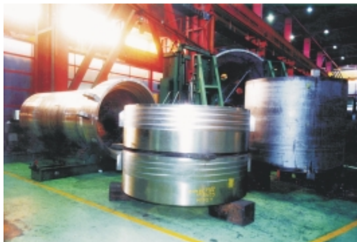
Proceso de fabricación del contenedor para el combustible gastado de Trillo (DPT) en la factoría de ENSA (Santander).
