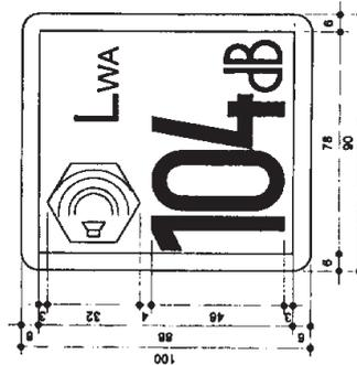
En caso de que la indicación se reduzca o se amplie en función del tamaño de la máquina, se respetarán las proporciones indicadas en el dibujo anterior. No obstante, la dimensión vertical de la indicación no será, en la medida de lo posible, inferior a 40 mm.
