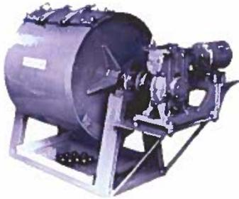
IMAGEN: MÁQUINA PARA EL ENSAYO DE DESGASTE DE LOS ÁNGELES
